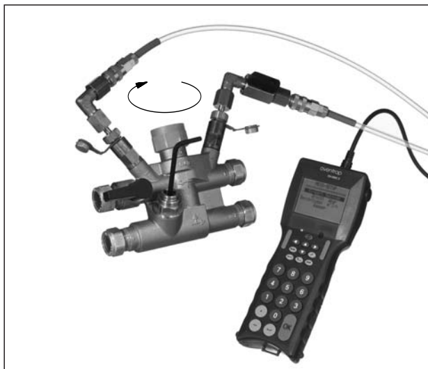
Рис. 2 Преднастройка посредством измерения перепада давления
